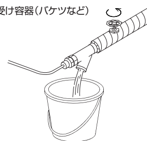
(図9) 給水ストレーナからフラッシングする場合
