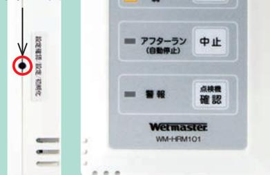
③で点灯していた表示灯が消灯し、「加湿」表示灯、「警報」表示灯が点灯します。
