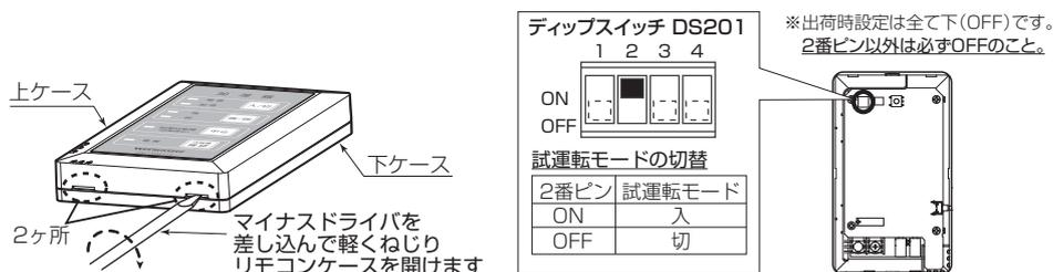
※試運転モードを使用せず、ヒューミ付リモコンの湿度検知による試運転を行う場合は、別冊の施工要領書 / 設定要領書を参照し設定変更を行ってください。
