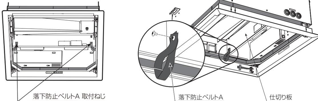
⑤グリルパネルの回転軸をグリル枠の金具にはめ込み、グリル枠へグリルパネルを取り付けます（図-9）。
