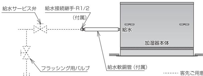
※加湿器への給水配管には、給水サービス弁およびフラッシング用バルブをメンテナンス上、必ず設けてください。図は一例です。現場の都合に応じてフラッシングが行えるように配管してください。
