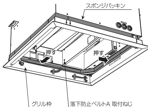
④図-8を参照し、グリル枠に取り付けられている落下防止ベルトAを加湿器本体内の仕切り板へ取り付けます（左右2箇所）。加湿器本体内の仕切り板に取り付けられている落下防止ベルトA取付ねじ（図-8）を外し、落下防止ベルトの穴に通して、元の位置へ取り付けてください。
