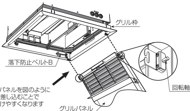
図-10 落下防止ベルトの固定
