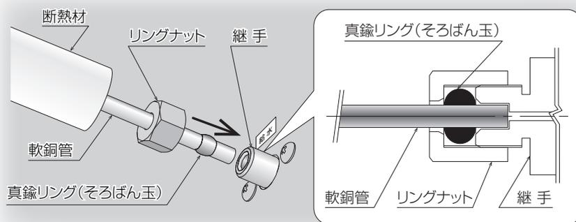
※軟銅管は、継手の奥までまっすぐにしっかりと差し込み、必ず2本のレンチを使ってナットを締めてください（付属の給水接続継手側）。
