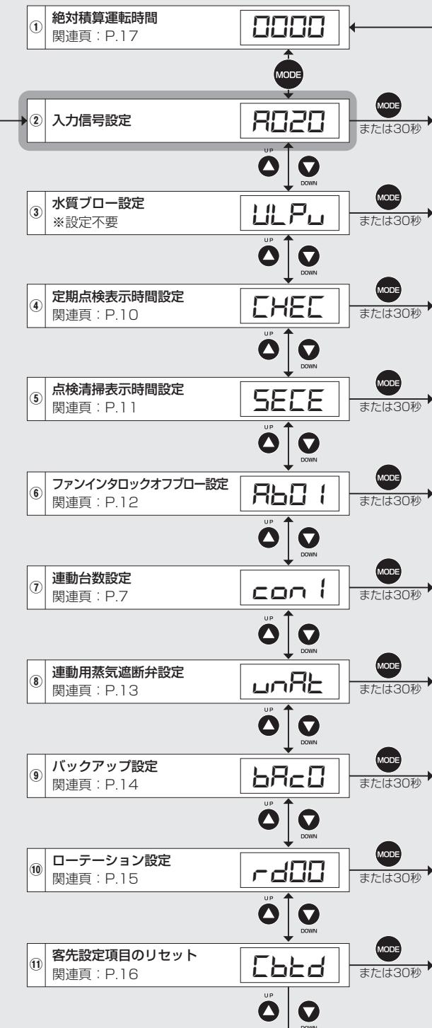
● 電源スイッチをONにした後、親機操作パネルのMODEボタン( )を押します(電源スイッチON後の操作パネルの画面遷移についてはP.7「参考:電源スイッチON時の動作」を参照)。
