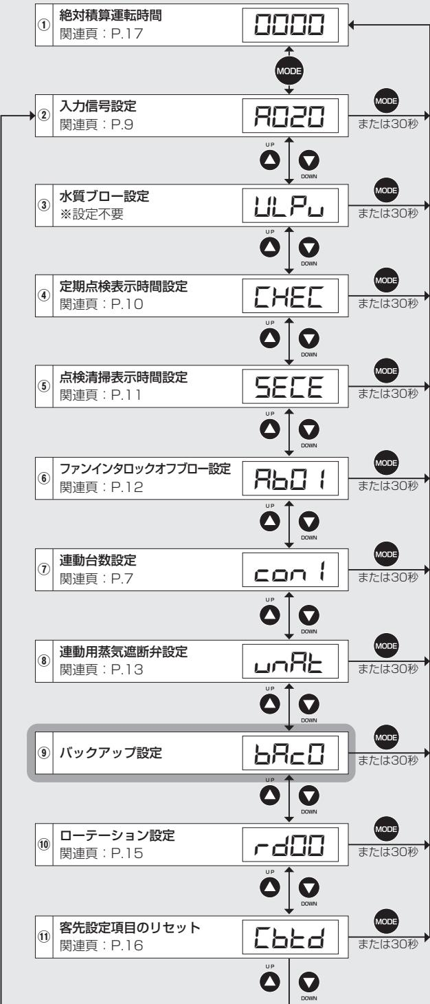
● 電源スイッチをONにした後、操作パネルのMODEボタン(**MODE**)を押します(電源スイッチON後の操作パネルの画面遷移についてはP.7「参考:電源スイッチON時の動作」を参照)。
