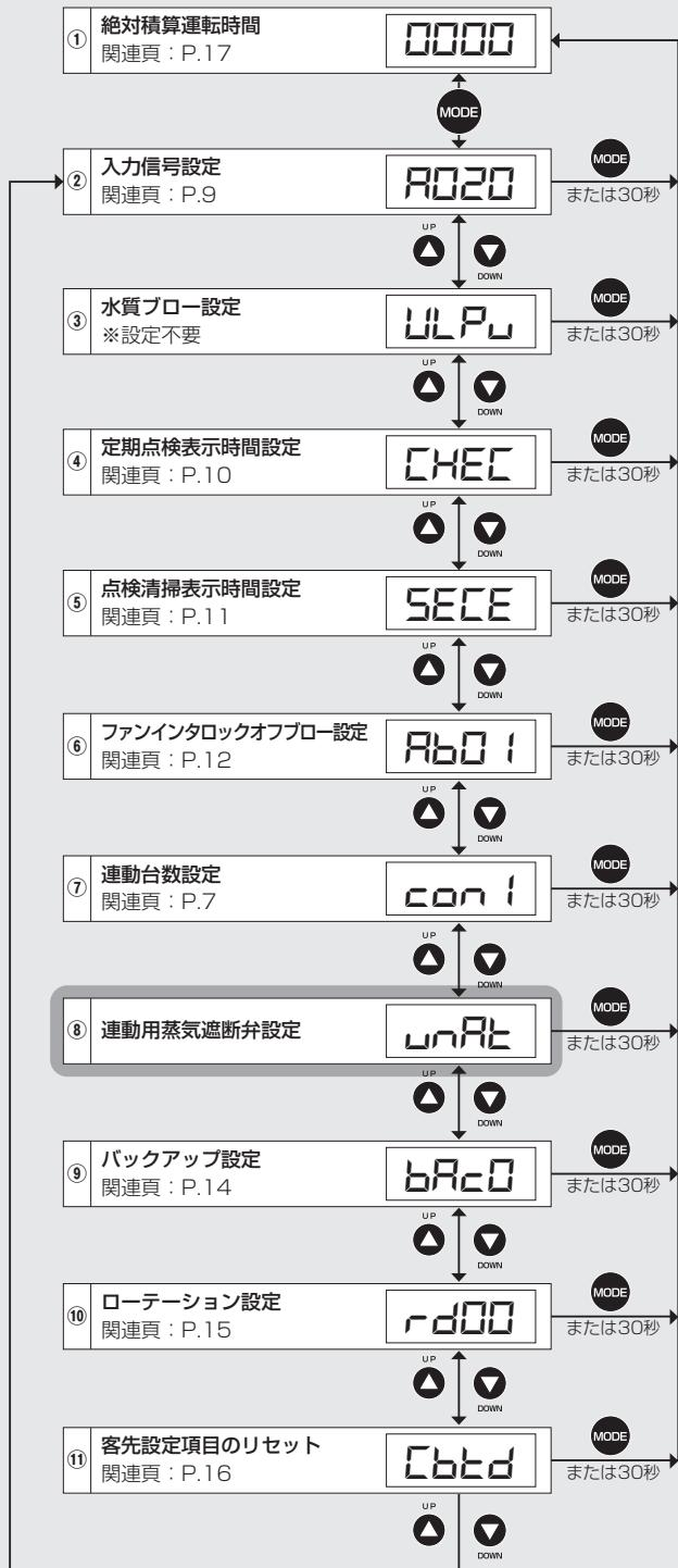
● 電源スイッチを ON にした後、親機操作パネルの MODE ボタン (MODE) を押します (電源スイッチ ON 後の操作パネルの画面遷移については P.7 「参考：電源スイッチ ON 時の動作」を参照)。
