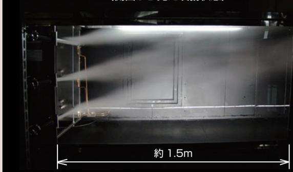
蒸気が帯状に流れ (層流)、1.5m を過ぎても蒸気は白く見える状態。
