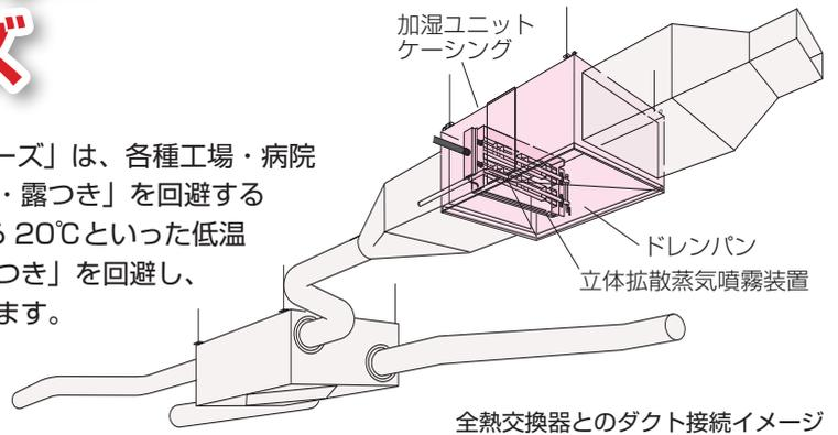
スチームブレンダーの蒸気噴霧機構は、蒸気噴霧管とこれに対向するボックスディフューザ、蒸気ホースを接続する分岐ヘッダ類、装置全体を支持するケーシングから構成されています。
