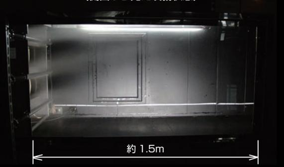
気流断面に対し均一に噴霧され、蒸気が白く見える部分は噴霧直後だけで、蒸気が空気にとけ込んでいる。
