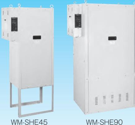
**間接蒸気式加湿器**は、病院、工場、地域冷暖房(DHC)など高圧蒸気の供給を受けられる空調設備に使用する加湿器です。ボイラからの供給蒸気(一次蒸気)により加湿器加熱タンク内の水を加熱し間接的に加湿蒸気(二次蒸気)を発生させるもので、従来の一次蒸気の噴霧による加湿とは異なり、蒸気-蒸気の熱交換により配管中の汚れや不純物を含まないクリーンな加湿が得られます。また供給蒸気を消費せず凝縮水として還水でき、熱効率やボイラの水質管理面からも有利です。
