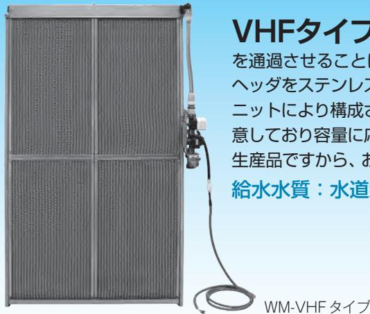
**VHFタイプ**は、主として空調機や全熱交換器の加熱コイル二次側に取り付けて、気流を通過させることにより加湿を行う滴下浸透気化式加湿器です。加湿モジュールおよび給水ヘッダをステンレス製フレームにおさめた本体と、減圧弁・電磁弁などを組み合わせた給水ユニットにより構成されています。飽和効率別に奥行寸法の異なる5種類の加湿モジュールを用意しており容量に応じて選択します。コイル寸法など空調機仕様に合わせて設計製作する受注生産品ですから、お客様のニーズにマッチした加湿器を提供することができます。
