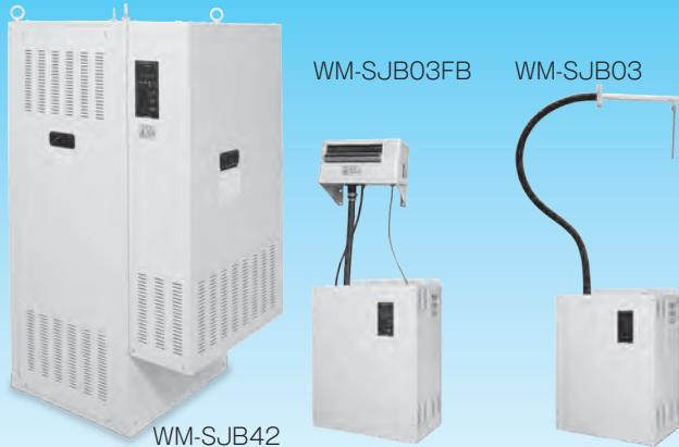
**電熱式蒸気加湿器**は、加湿器加熱タンク内の水を電熱ヒータで加熱して蒸気を発生させるもので、電熱ヒータの制御にはソリッドステートリレーを採用、予熱機能も装備して蒸気発生の立ち上がり時間が短く、制御の応答性に優れています。標準仕様の製品で軟水・一次純水どちらの水質でもご使用いただけます。1台で比例制御・ON-OFF制御の何れにも対応します。蒸気噴霧管を使用する空調機器組込型7型番、蒸気プロアを使用する室内直接噴霧型3型番を用意しています。
