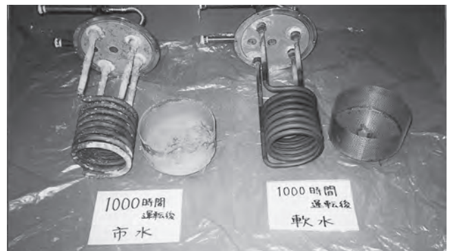
加熱コイルなどへのスケール付着の相違（1,000時間経過後）
