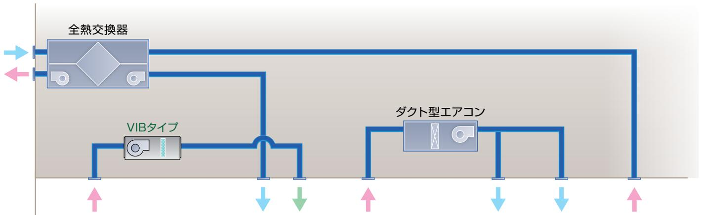
全熱交換器、エアコン等の空調機への組込加湿は行わず、加湿はVIBタイプで単独加湿を行います。全熱交換器組込加湿はその交換効率に影響を受け加湿能力が変わります。また、エアコン組込加湿はエアコンの運転モード（暖房、冷房、送風）に影響を受け加湿能力が変わります（その他の外気処理空調機組込加湿も同様です）。
