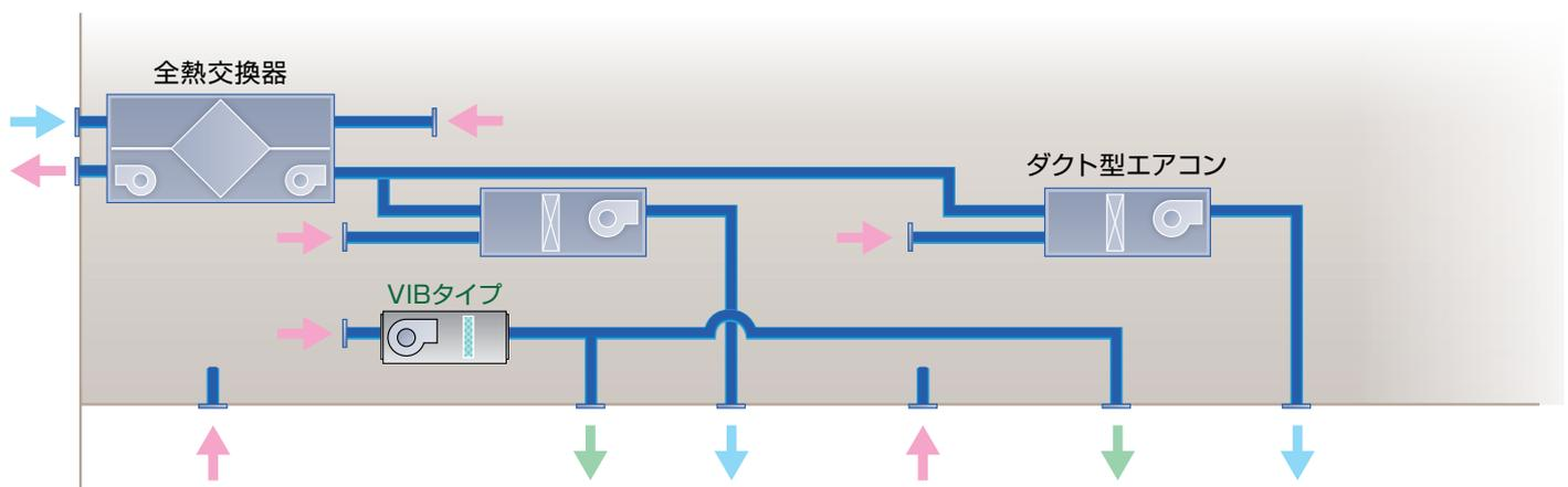
室内循環と同様に天井内チャンバ方式での単独加湿も加湿器吸込空気はほぼ安定しているため、加湿器入口空気温度の大きな変化はなく安定した加湿量が得られ、湿度管理しやすい方法と言えます。
