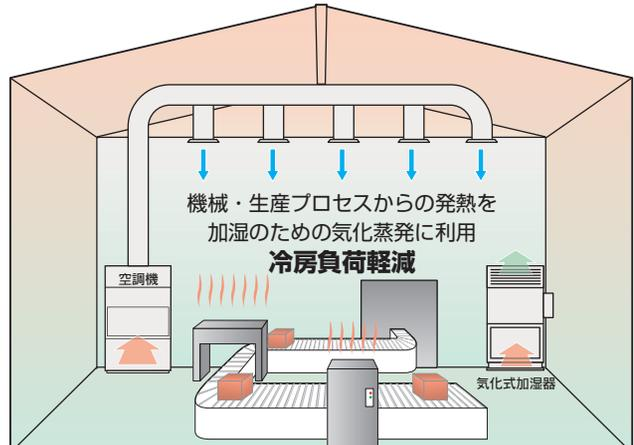
高温空気で確実に室内へ加湿します。機械・生産プロセス等の機器から発生する熱を水の気化蒸発に利用し、空調機の冷房負荷の軽減に寄与します。
