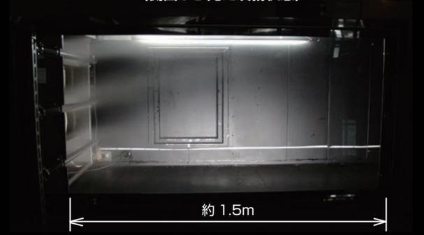
気流断面に対し均一に噴霧され、蒸気が白く見える部分は噴霧直後だけで、蒸気が空気にとけ込んでいる。
