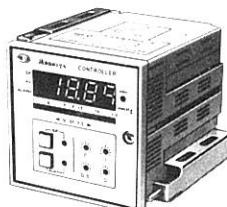
差圧・風量などの制御対象が設定された目標値に対し誤差を生じた場合、この誤差信号を演算して最短時間で誤差を修正する制御信号を送り出すものです。制御信号は4~20mA DCでPID動作ができます。
