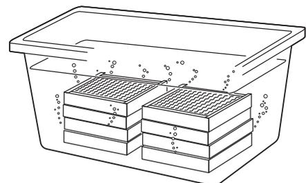
8) 漬け置きしたら加湿モジュールを取り出して十分に水洗いをしてください。その後、静置して水気を落とし、乾燥させます。
