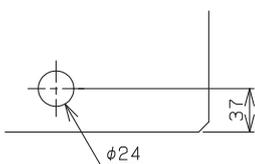
※空調機背面パネルに加湿器排水ホースを貫通させるためのφ24穴加工を行ってください。
