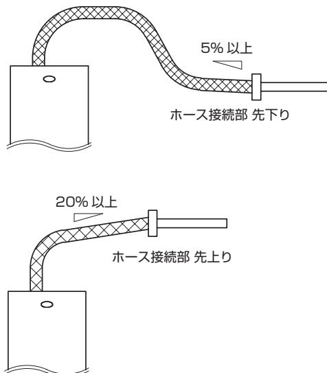
\*図5、図6は加湿器本体と蒸気噴霧管を接続するにあたっての蒸気ホースの取り回しを表したイメージ図です。
