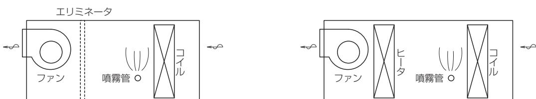
●蒸発吸収距離が不足する場合や流通空気の温度が低くなる場合は、立体拡散蒸気噴霧装置(WM-SBAタイプ)の設置やエリミネータの設置、空気の予熱、防水・防錆が必要となることがあります。
