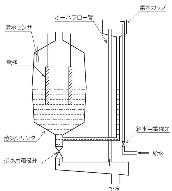
SEB25C～65C には排水用電磁弁のかわりに排水ポンプが付きます。
