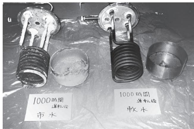
◇上の写真は、間接蒸気式加湿器への給水に、水道水（市水）と軟水を使用し、1,000 時間運転した後の結果です。
